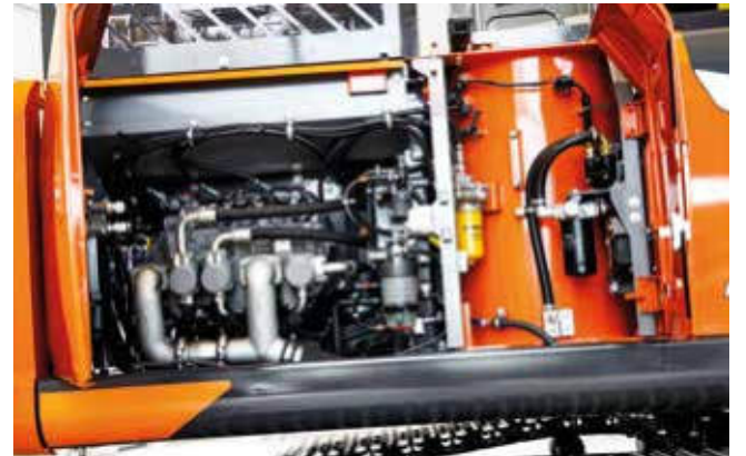
TRIAS III hidrolik sistemi ile %10'a kadar yakıt tasarrufu sağlanır.
